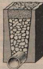
Drenaje de tubería de plástico
