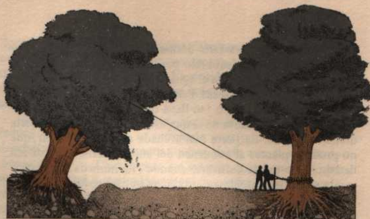
Utilización de una cabra pequeña Emplee la base de un árbol como punto de amarre, y sujete el cable, lo más alto
