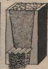
Drenaje de matorral
