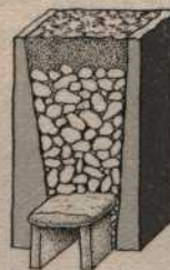
Drenaje de alcantarilla de piedra
