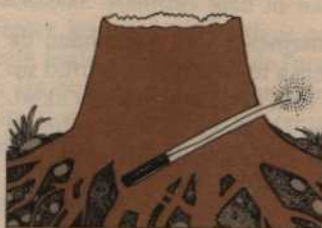
Voladura de un tocón Introduzca la carga explosiva en un orificio profundo bajo el tocón y aléjese del mismo.
